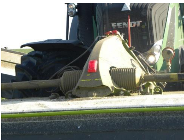
Obr. 55 Umístění piezosirény na žacím stroji
